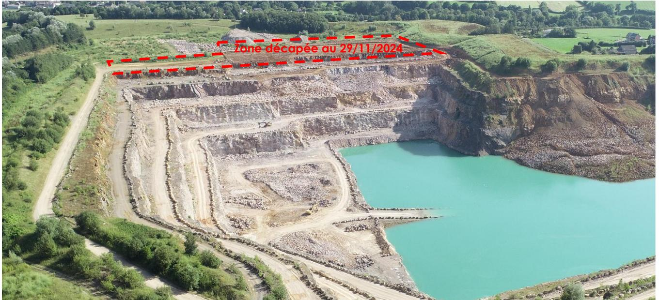
→ une zone en cours d'extraction constituée de plusieurs niveaux exploités simultanément qui progressent vers le sud, exploitée à sec à l'aide d'un pompage d'exhaure
