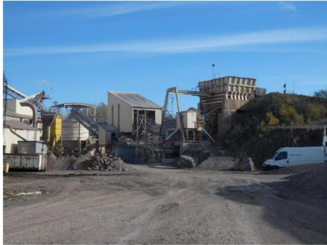
▲ A droite trémie du primaire, au centre l'unité de traitement secondaire à sec, à gauche les installations tertiaires
