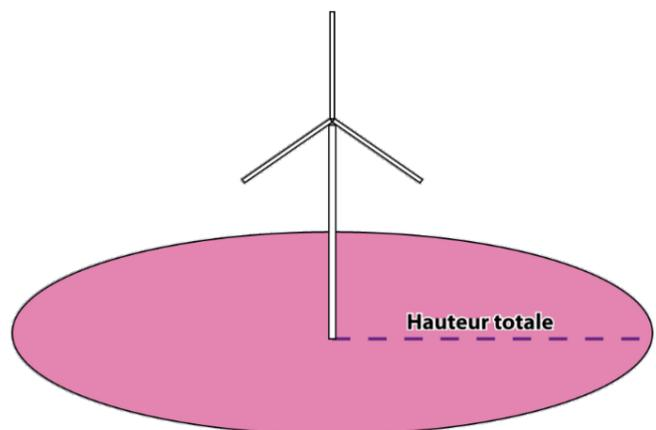
Figure 12 : Zone d'effet du phénomène d'effondrement de l'éolienne
