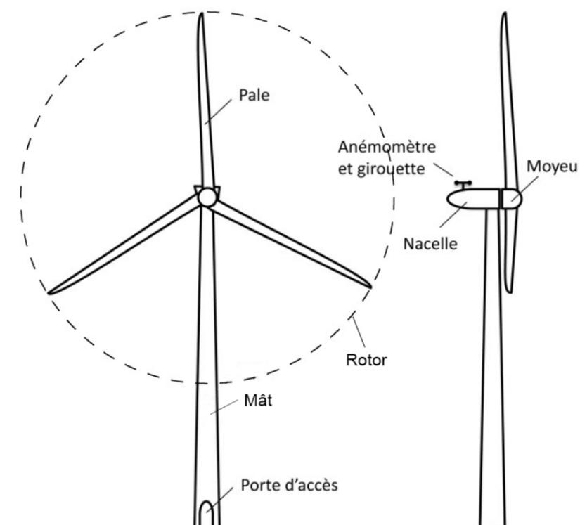
Figure 3 : Schéma simplifié d'un aérogénérateur
