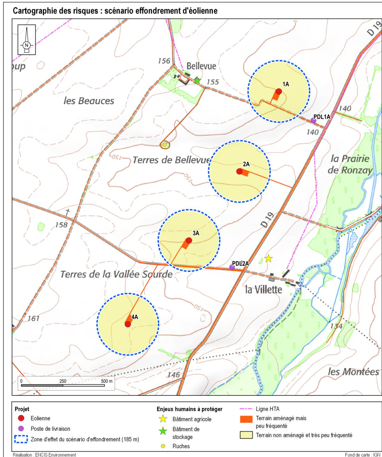
Carte 12 : Cartographie des enjeux identifiés dans les zones d'effet du scénario d'effondrement d'éolienne
