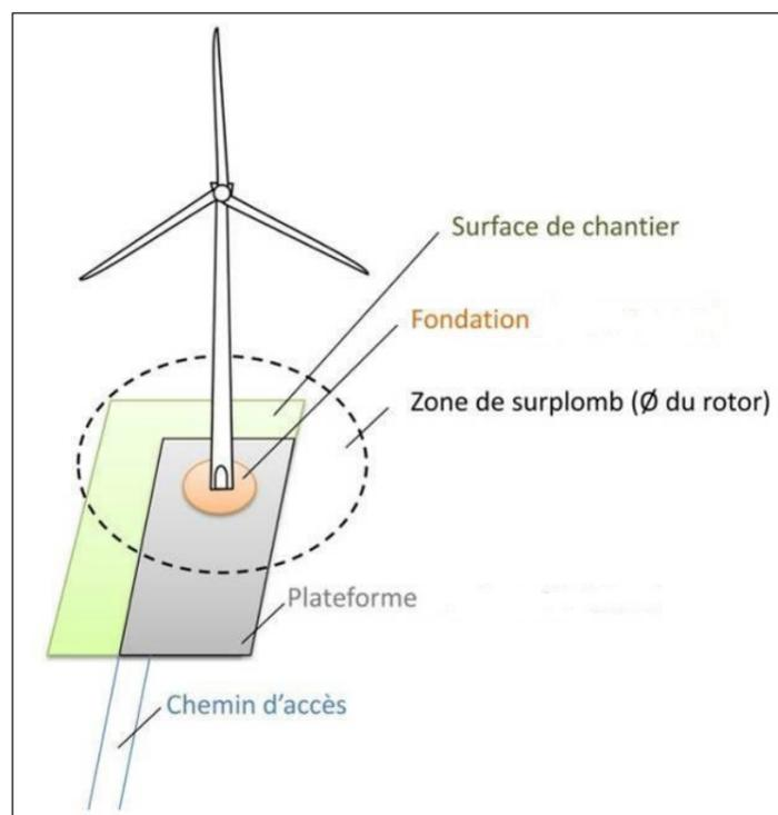
Figure 3 : Illustration des emprises au sol d'une éolienne
