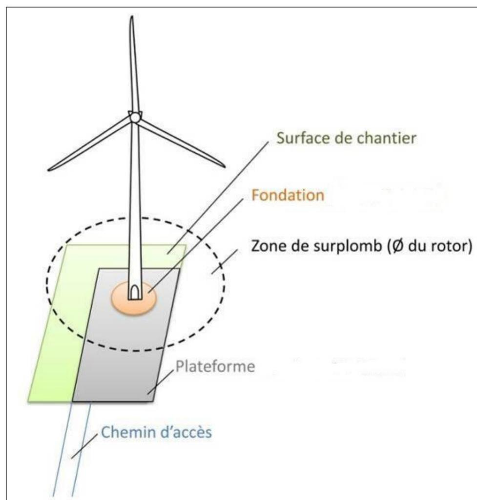
Figure 4 : Illustration des emprises au sol d'une éolienne
