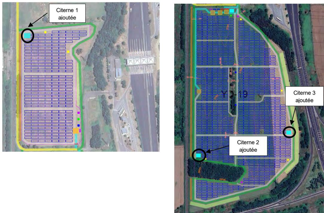
Figure 1. Extraits des plans de masse montrant les citernes ajoutées, « Trémège 2 » à gauche, « Trémège 1 » à droite
