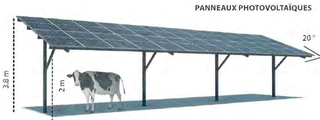
Figure 4 : schéma de structures photovoltaïques du projet de Trémège (étude paysagère-composite)
