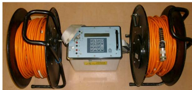
Figure 14 : Présentation de l'équipement de tomographie de résistivité électrique
