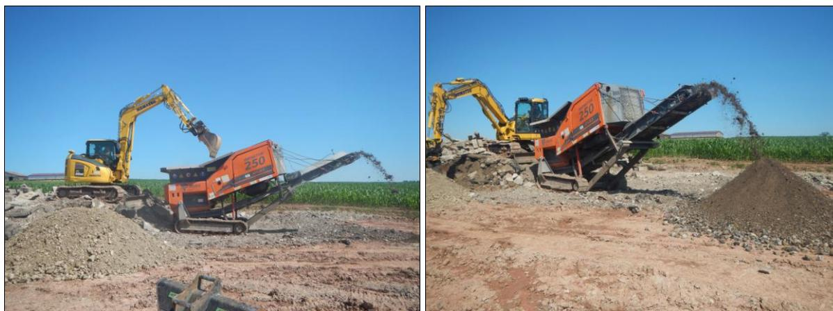
Figure 52 : Essais de broyage pour mesures de bruit en juillet 2024
