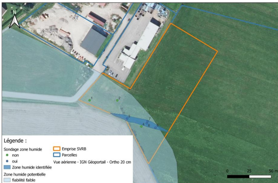
Localisation des investigations et résultats sur les sols (source : SEMACO Environnement)
