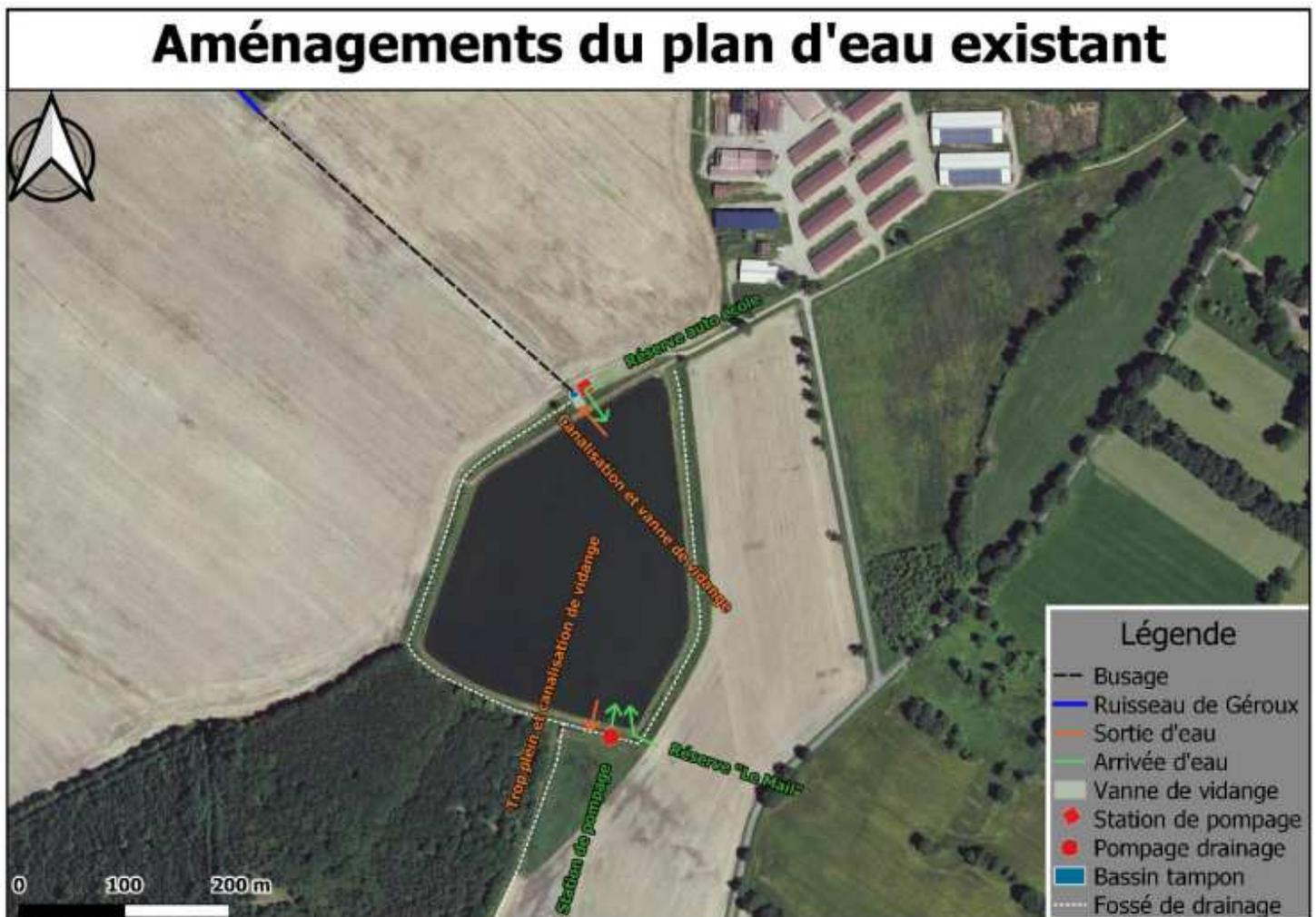
Figure 6 : Fonctionnement du plan d'eau actuellement
