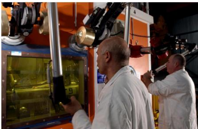
Travail au télémanipulateur en cellule blindée (remarquer la vitre blindée qui fait 1 m d'épaisseur)
