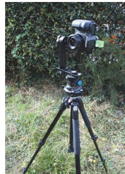
Figure 1 : dispositif d'acquisition d'images en séquence panoramique
