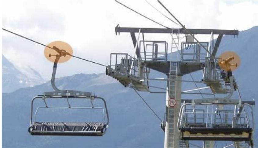
Figure 5 – Photographie de pinces sur un télésiège débrayable (d'après Remontées-mécaniques.net)
