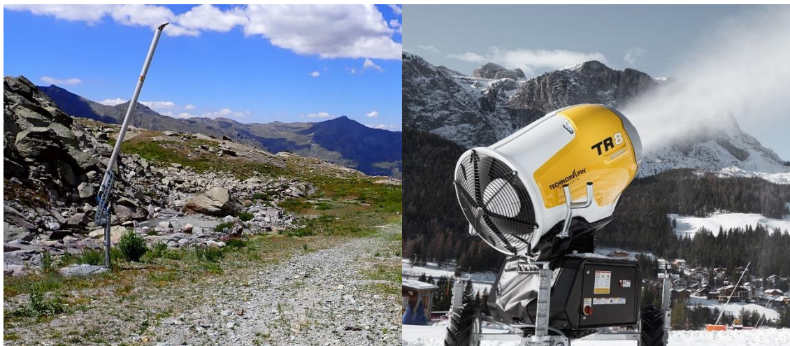
Enneigreur bi fluide (gauche) et mono fluide (droite). Source : KARUM et TechnoAlpin.
