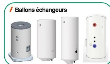
L'ensemble des produits est composé d'une cuve d'acier mécanosoudée et émaillée à l'intérieur. Elle est entourée d'un manteau d'acier peint et de deux fonds en plastiques. De la mousse polyuréthane est injectée entre la cuve et le manteau afin d'assurer l'isolation thermique et le maintien de l'ensemble. Des composants sont ensuite montés essentiellement manuellement. Les CE Thermodynamiques font l'objet d'un montage spécifique afin d'intégrer les pompes à chaleur.
