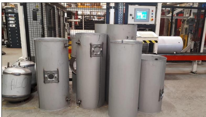
*Photo de tôles enroulées pour former le corps des chauffe-eaux*
