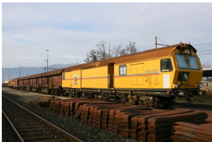
Train meuleur de rails (Scheuchzer S.A.)
