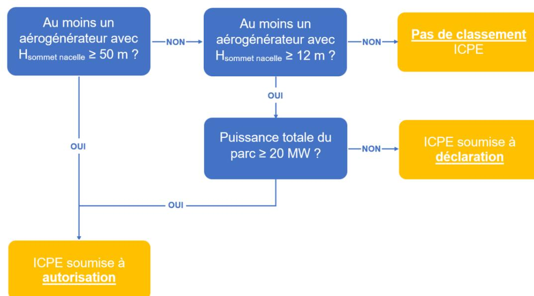
Figure 2 : Détermination du régime ICPE d'un parc éolien
