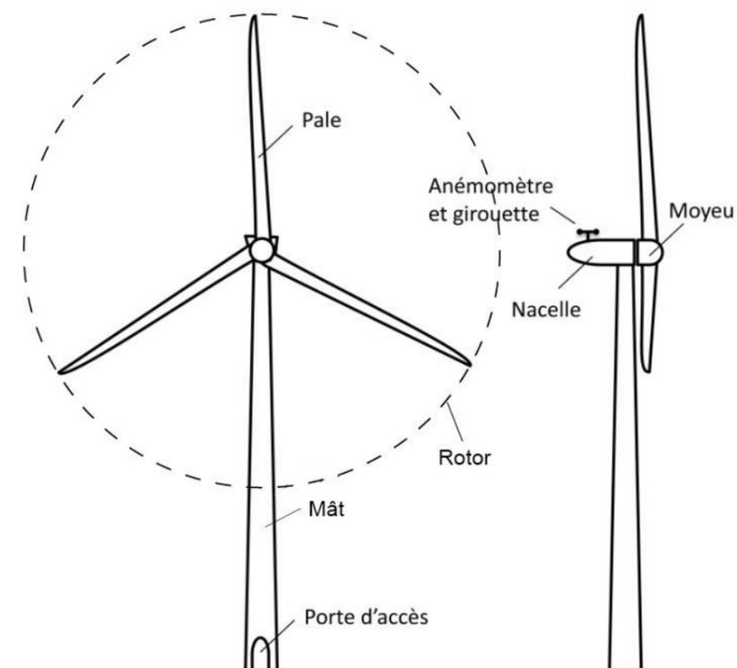
Figure 7 : Schéma simplifié d'un aérogénérateur
