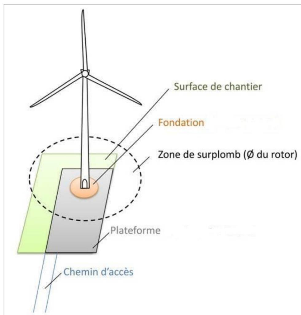
Figure 8 : Illustration des emprises au sol d'une éolienne
