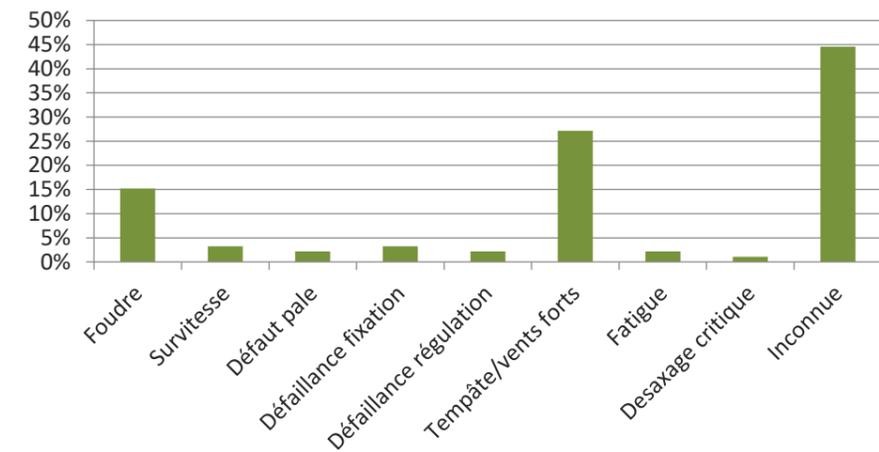
Figure 13 : Répartition des causes premières de rupture de pale dans les accidents à l'international entre 2000 et 2011
