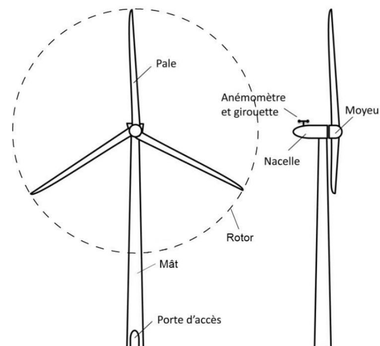
Figure 6 : Schéma simplifié d'un aérogénérateur (Source : d'après le Guide technique, Mai 2012)
