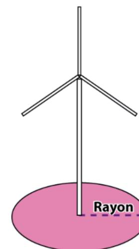
Figure 18 : Zone d'effet du phénomène de chute d'éléments de l'éolienne
