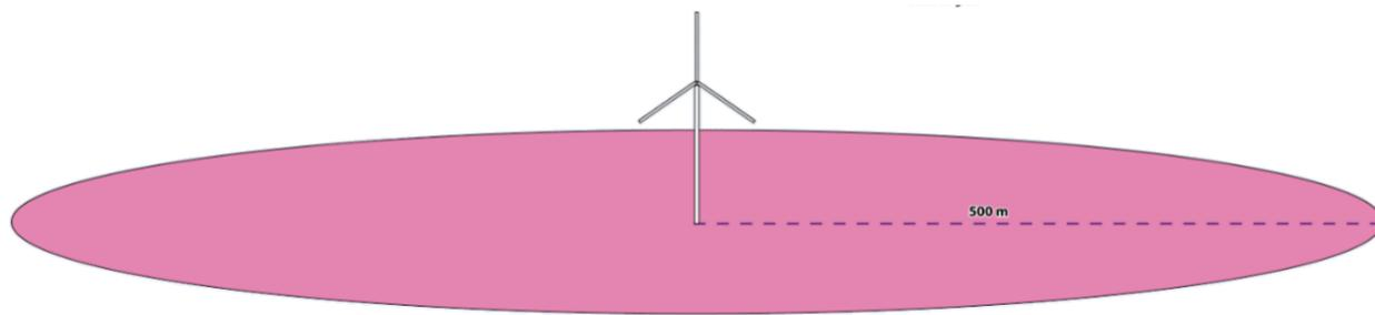
Figure 19 : Zone d'effet du phénomène de projection de pales ou de fragments de pales
