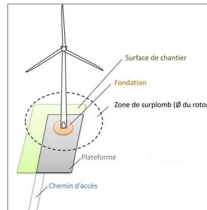
Figure 7 : Illustration des emprises au sol d'une éolienne (Source : Guide technique, Mai 2012)
