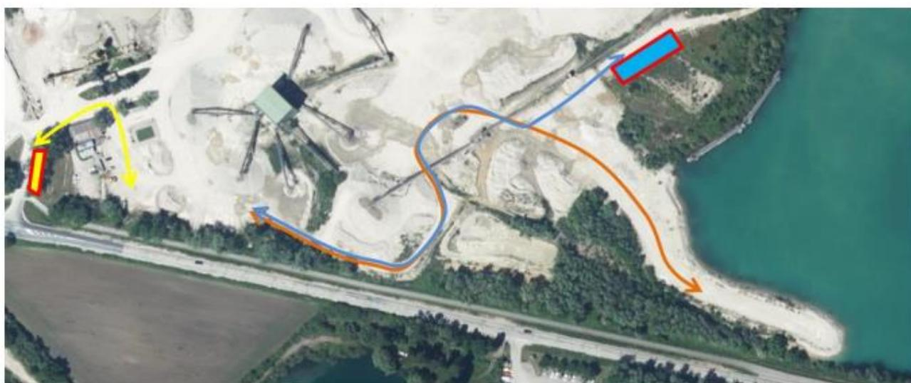
**Figure 7.** Chemins utilisés par les chargeurs pour le ravitaillement en matériaux - Source : GÉNÉRALE DU SOLAIRE (étude d'impact)
