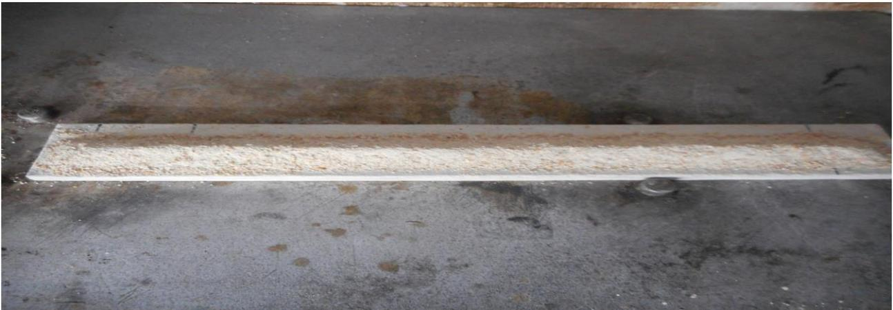
Vue de la traînée avant l'essai ONU N.1
