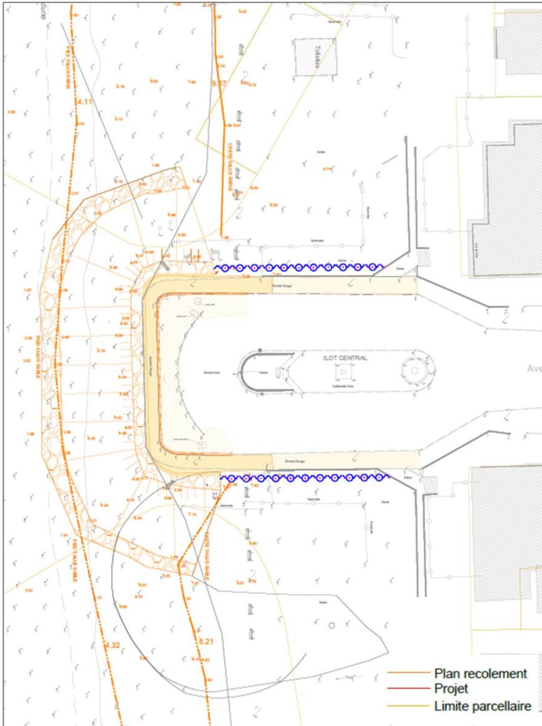
Planche 5: Vue en plan du projet de protection des parements latéraux de la colonne (EGIS, 2022).
