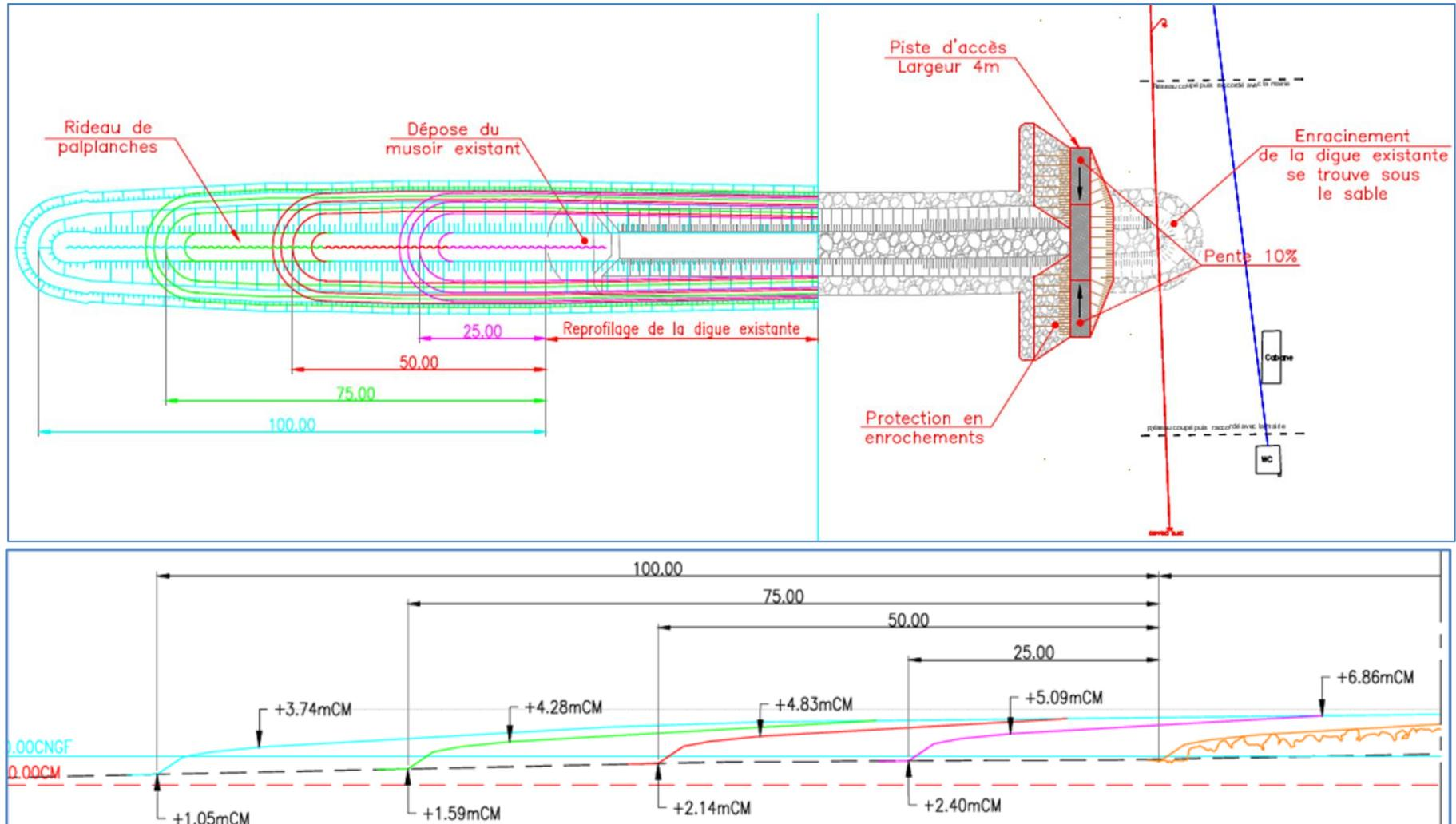
Planche 8: Vue en plan (en haut) et Profil en long (en bas) des 4 longueurs d'allongement de l'épi Sud envisagées (EGIS, 2022). NB : la longueur retenue d'allongement est de 60 m. Le plan finalisé sera produit au stade PRO.
