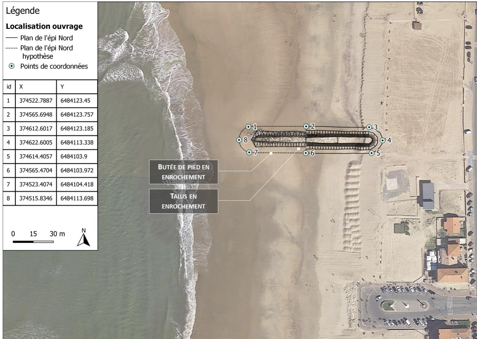
Planche 6: Plan de l'épi Nord (GUINTOLI/ECARTIP 2015) et coordonnées de l'ouvrage en Lambert 93.
