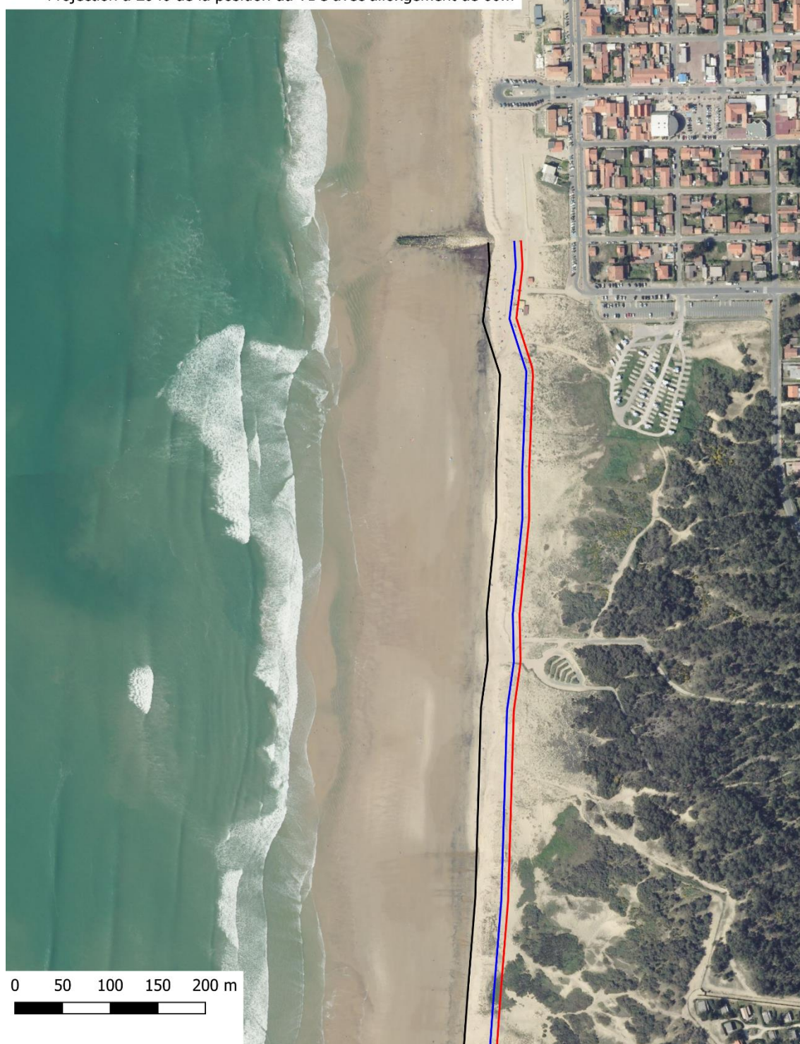
Planche 41: Projection de trait de côte à 2040 à l'aval de l'épi pour une valeur d'allongement de 60m par rapport à la configuration actuelle (i.e. sans allongement de l'épi, CASAGEC, 2022).
