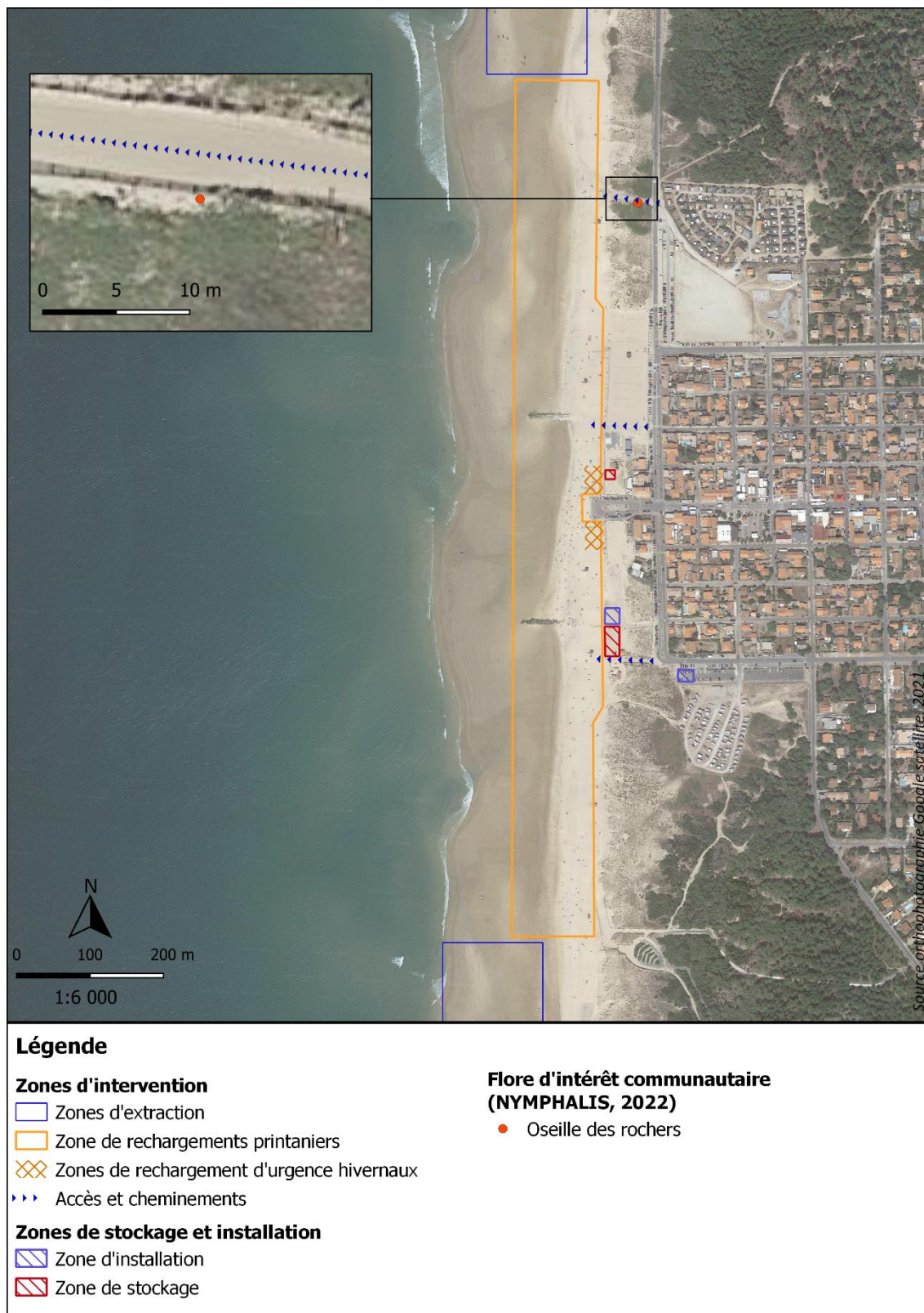
Planche 54: Croisement de la localisation des espèces d'intérêt communautaire avec les dispositions constructives pour les travaux d'extraction et de rechargement des sables (CASAGEC, 2023).
