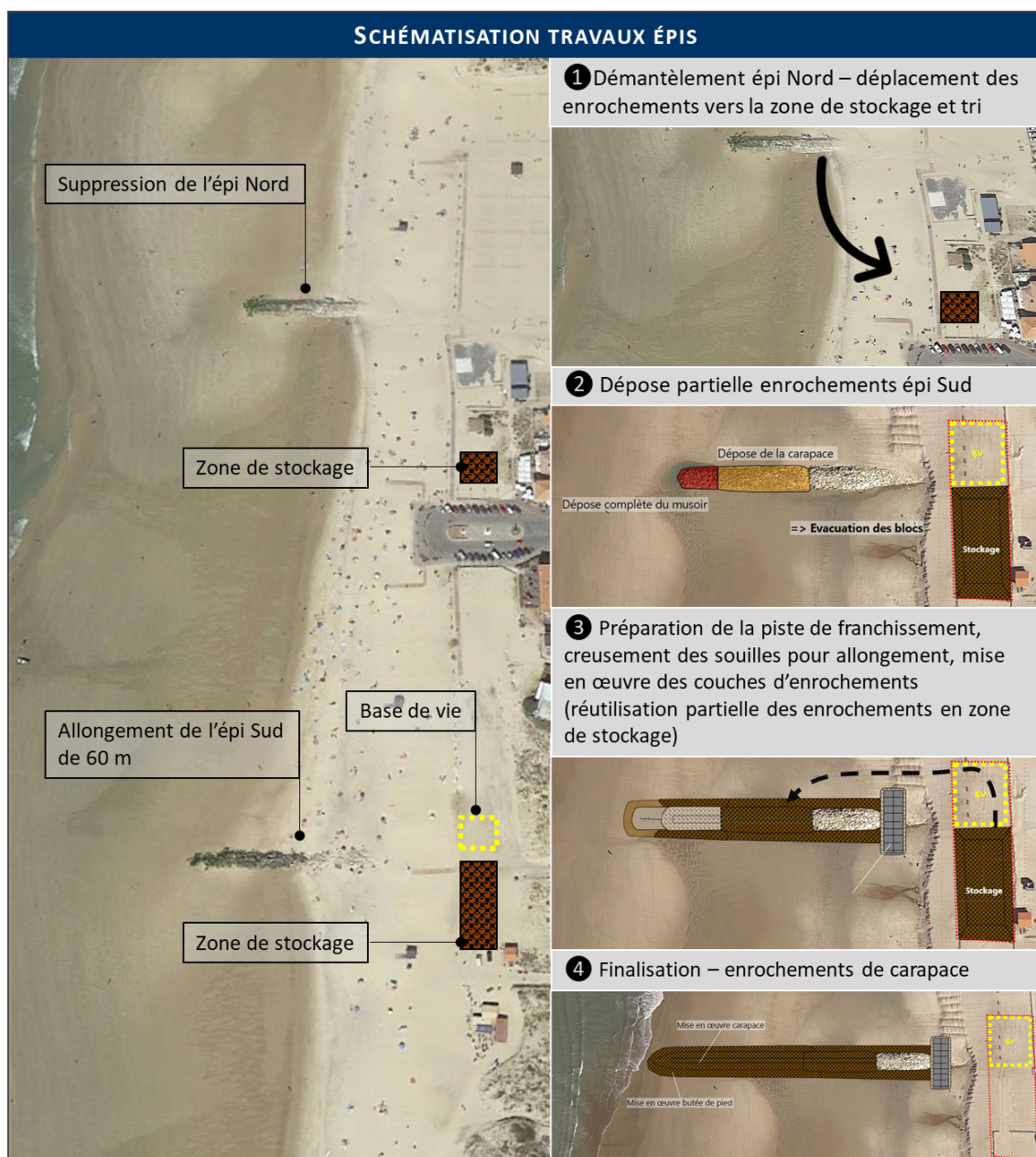
Figure 5: Schématisation des travaux sur les épis (EGIS/CASAGEC, 2023).
