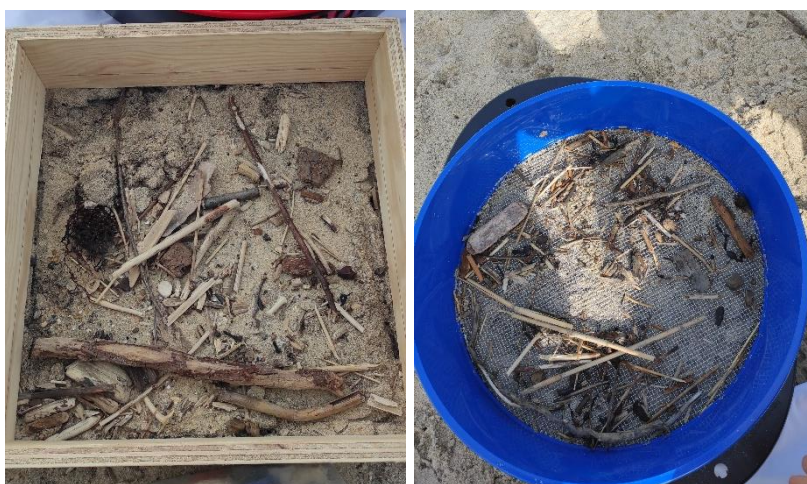
Figure 2 : quadrat (33x33 cm) et tamis utilisés
