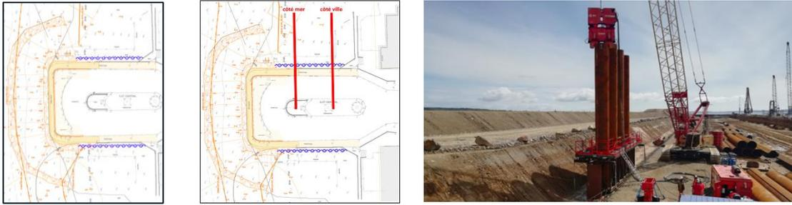
Figure 66: De gauche à droite : vue en plan d'un rideau métallique simple, d'un rideau avec tirants, et photographie d'installation d'un rideau mixte (EGIS, 2022).
