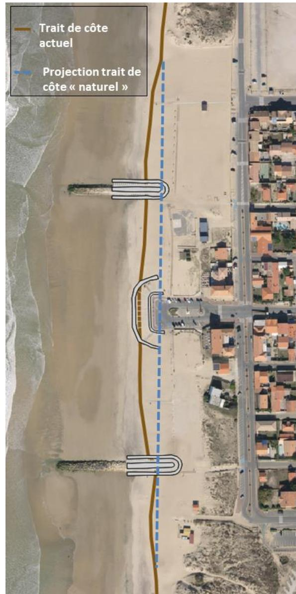
Figure 59: Schématisation du système de lutte contre l'érosion actuelle (CDC MA, 2020)
