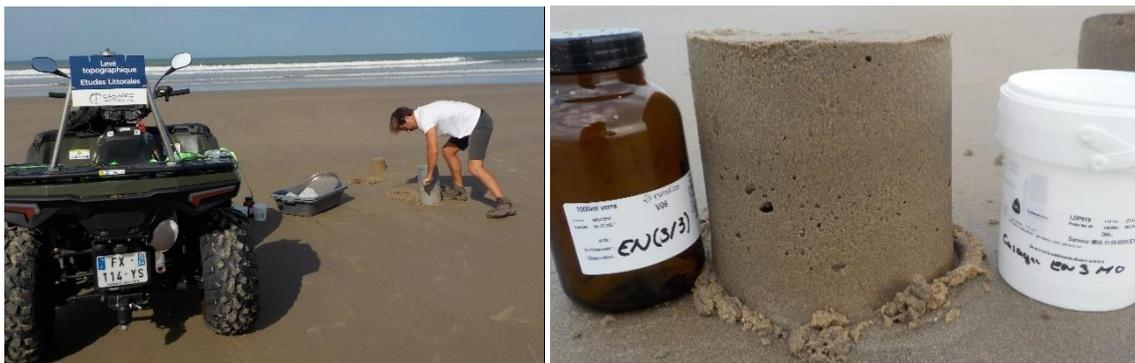
Figure 9: Prélèvement au carottier à main à gauche et exemple de carotte extraite à droite.
