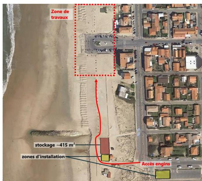
FIGURE 35 : LOCALISATION DES ZONES D'INSTALLATION ET DE STOCKAGE ENVISAGEES EN PHASE TRAVAUX
