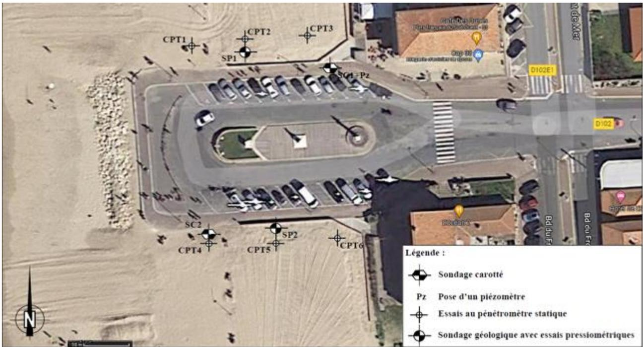
**FIGURE 14 : PLAN D'IMPLANTATION DES SONDAGES GEOTECHNIQUES (GEOTEC, 2022)**
