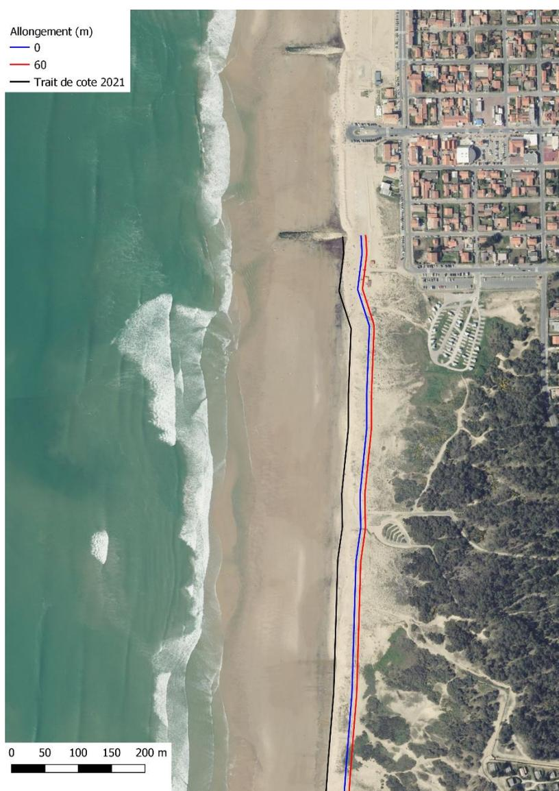
**Figure 6. Projection de trait de côte à 2040 à l'aval de l'épi pour une valeur d'allongement de 60m par rapport à la configuration actuelle (i.e. sans allongement de l'épi).**
