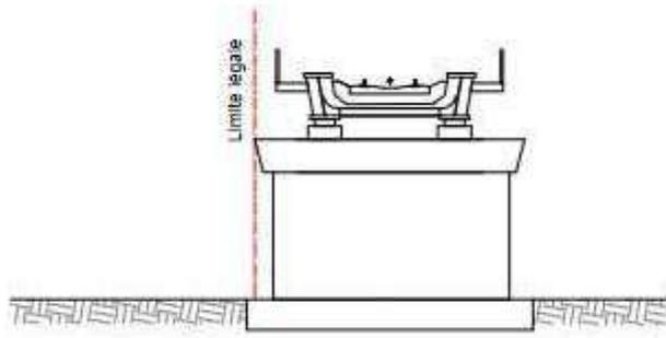
Ouvrage d'art aérien : voie ferrée portée par un pont-rail avec débord de tablier
