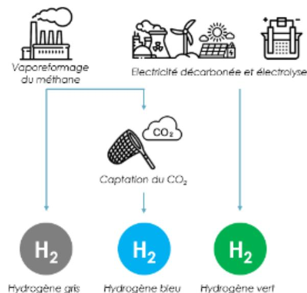
Figure 98: Schéma de la production d'hydrogène
