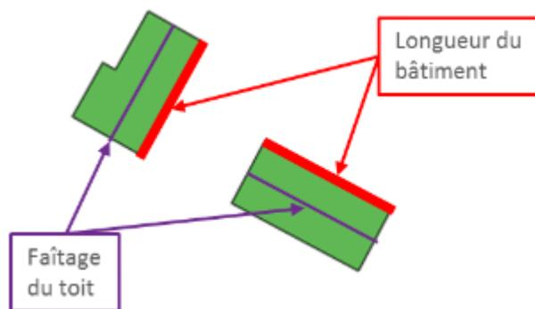
Figure 62 : Schéma pour déterminer l'orientation des toits
