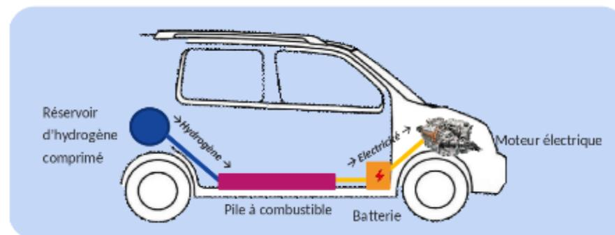
Figure 99: Schéma d'un véhicule hydrogène
