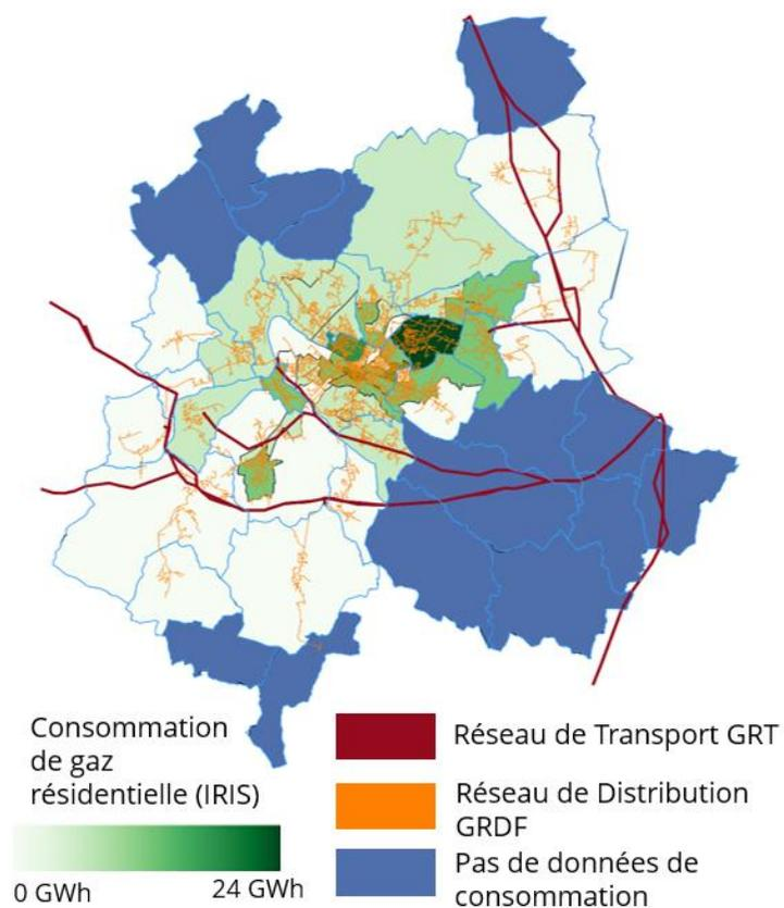
Figure 34: Cartographie des réseaux de gaz
