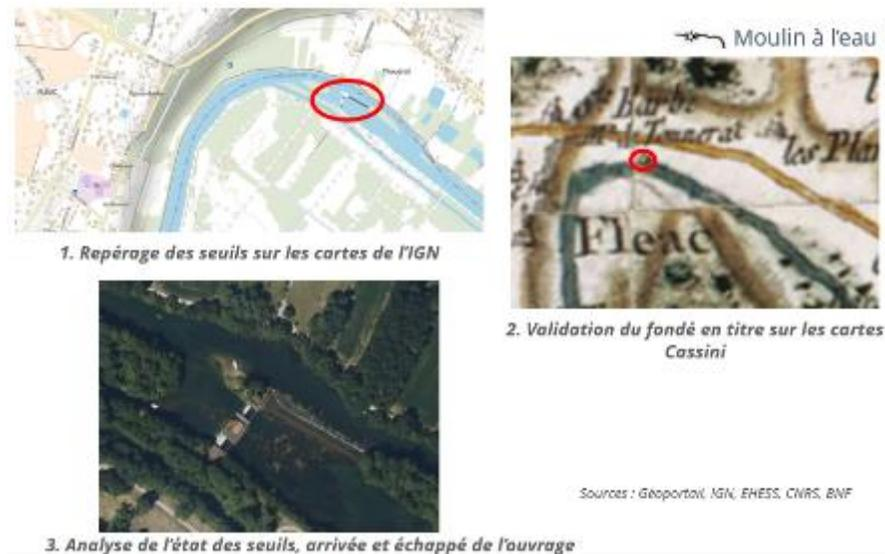
Figure 74: Exemple des étapes de réparaage d'un ouvrage
