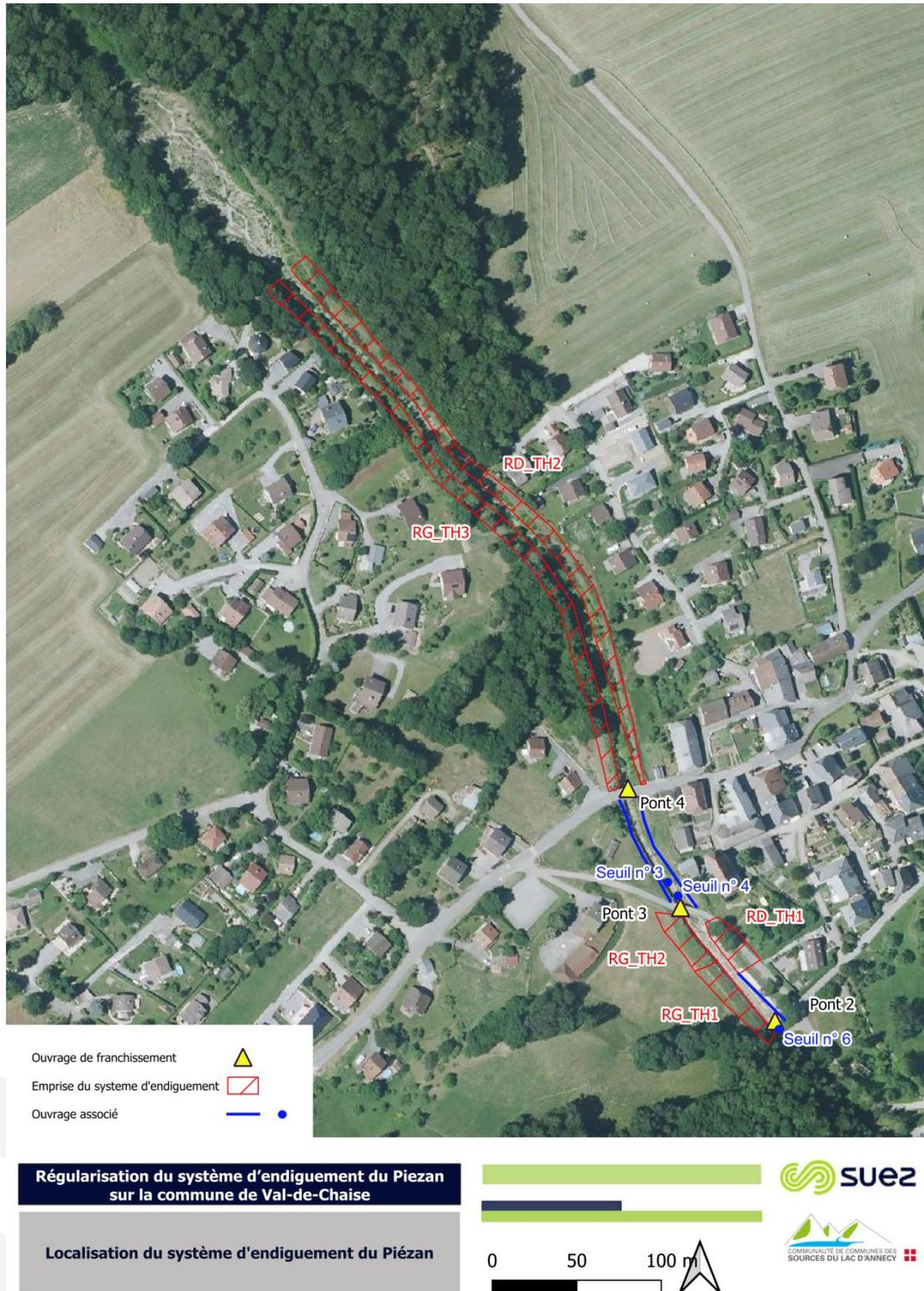
Figure 1 : Localisation des différents ouvrages du système d'endiguement
