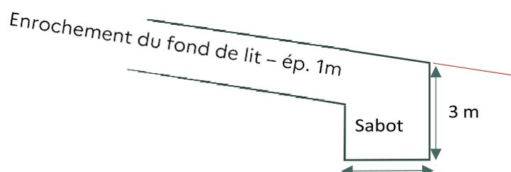
Figure 16 : Schéma de principe côté du sabot en enrochements libres
