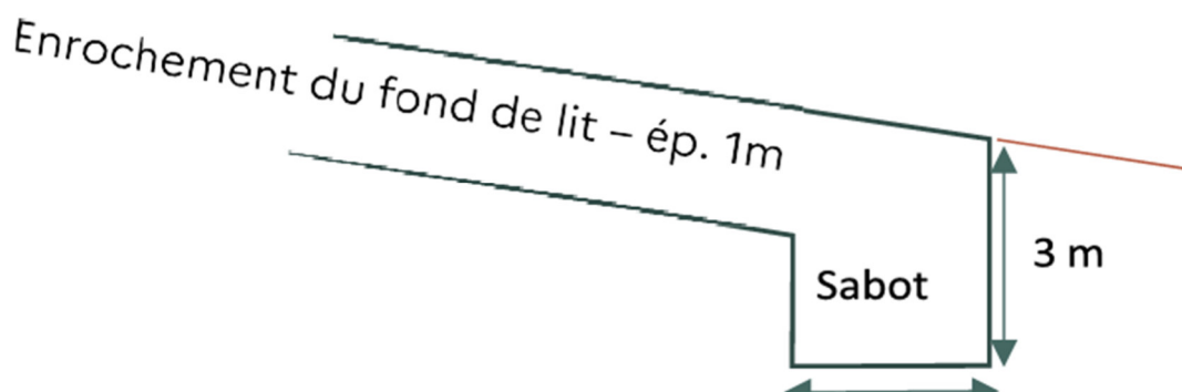
Figure 9 Schéma de principe du sabot para fouille en enrochements libres
