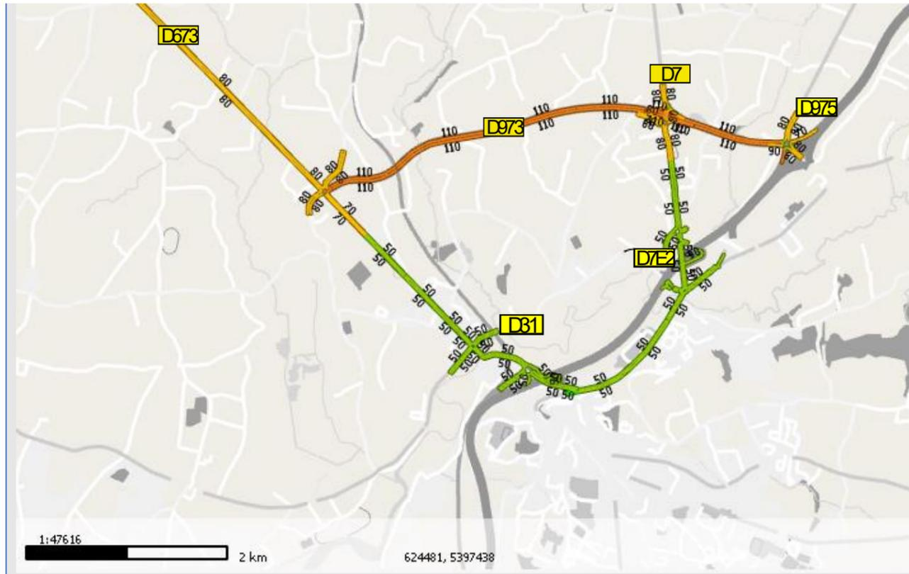
Figure 48 : vitesse maximale du réseau routier
