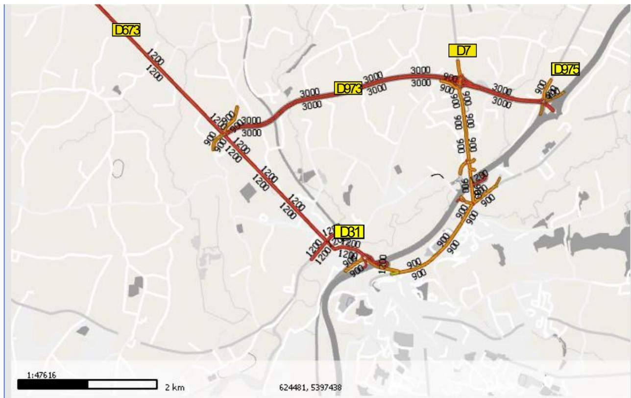
Figure 47 : capacité du réseau routier
