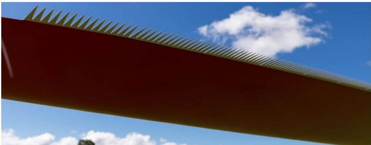
*Figure 50 - Exemple de serrations sur une pale d'éolienne (Source Energie Partagée)*
