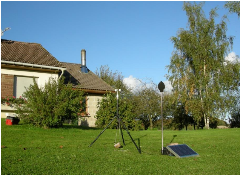
Figure 11 : Photographie d'un sonomètre en cours d'utilisation
