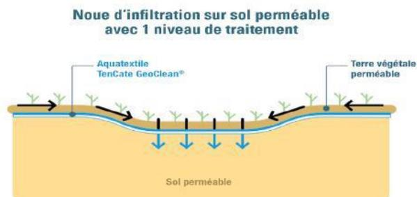
Avec l'activateur de croissance naturelle disponible sur les filaments continus bleus de l'aquatextile, les microorganismes présents dans le sol et l'eau vont rapidement coloniser sa structure poreuse pour dégrader systématiquement les hydrocarbures qui y sont fixés et maintenir la capacité de rétention de l'aquatextile sur le long terme.
