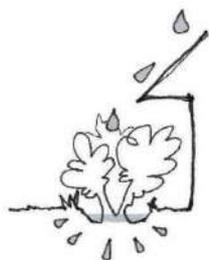
*Le processus de réten-tion-infiltration se caractérise par la création dans le sol d'un espace de réten-tion perméable à l'eau pluviale, tel qu'un jardin de pluie, une noue, etc. Cet aménagement permet à l'eau d'être retenue partiellement et ponctuellement avant son infiltration dans le sol puis dans la nappe phréatique.*
