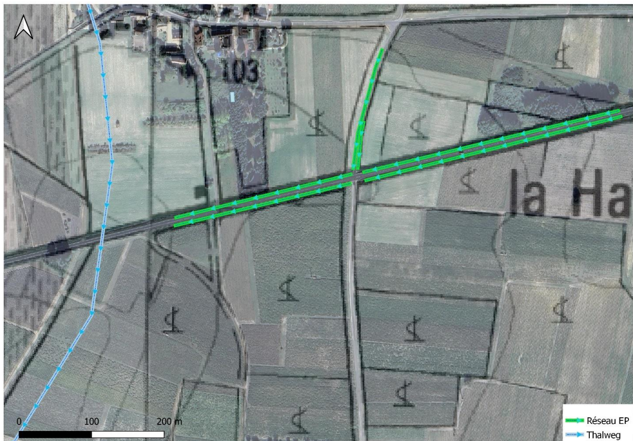
Figure 6- Fonctionnement du réseau EP existant
