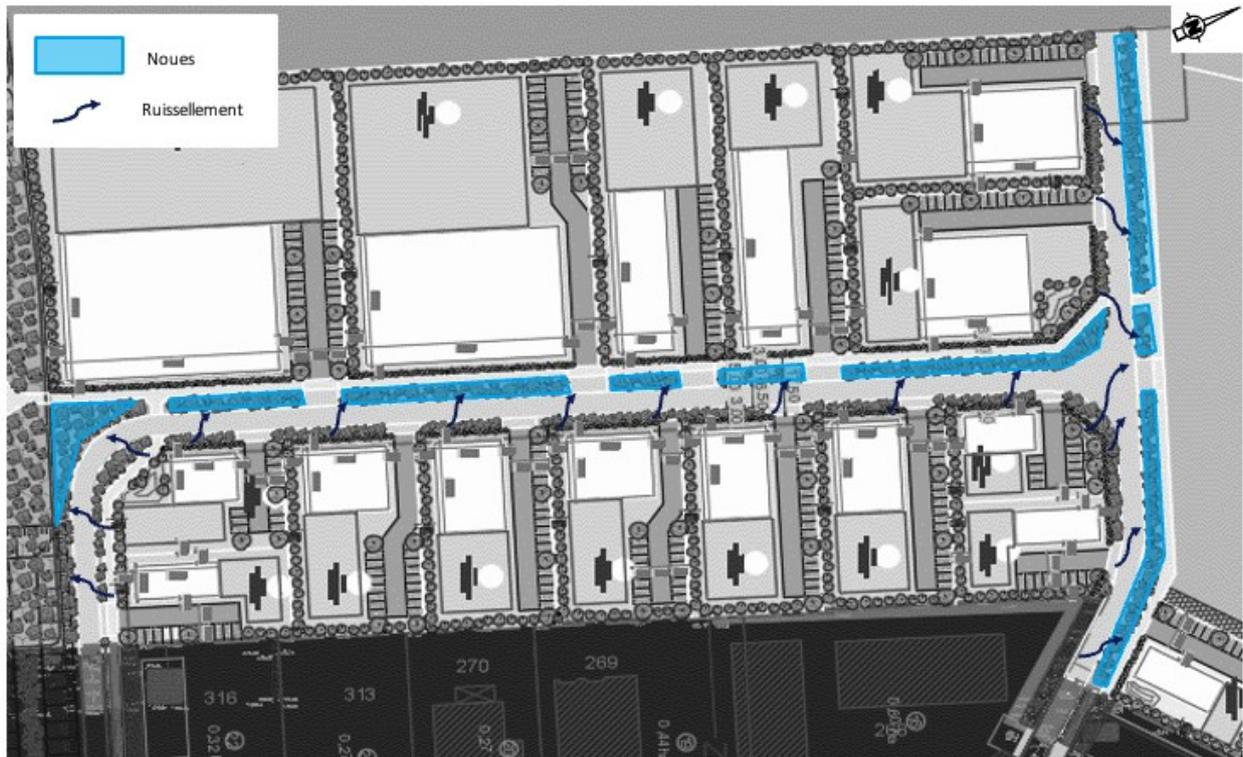
Illustration 15 : Plan des ouvrages d'infiltration
