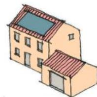
Les toitures 4 pentes, en plus du fait qu'elles ne correspondent que très peu aux registres des toitures locales et rendent difficiles les extensions, sont particulièrement inadaptées à l'installation de panneaux.
