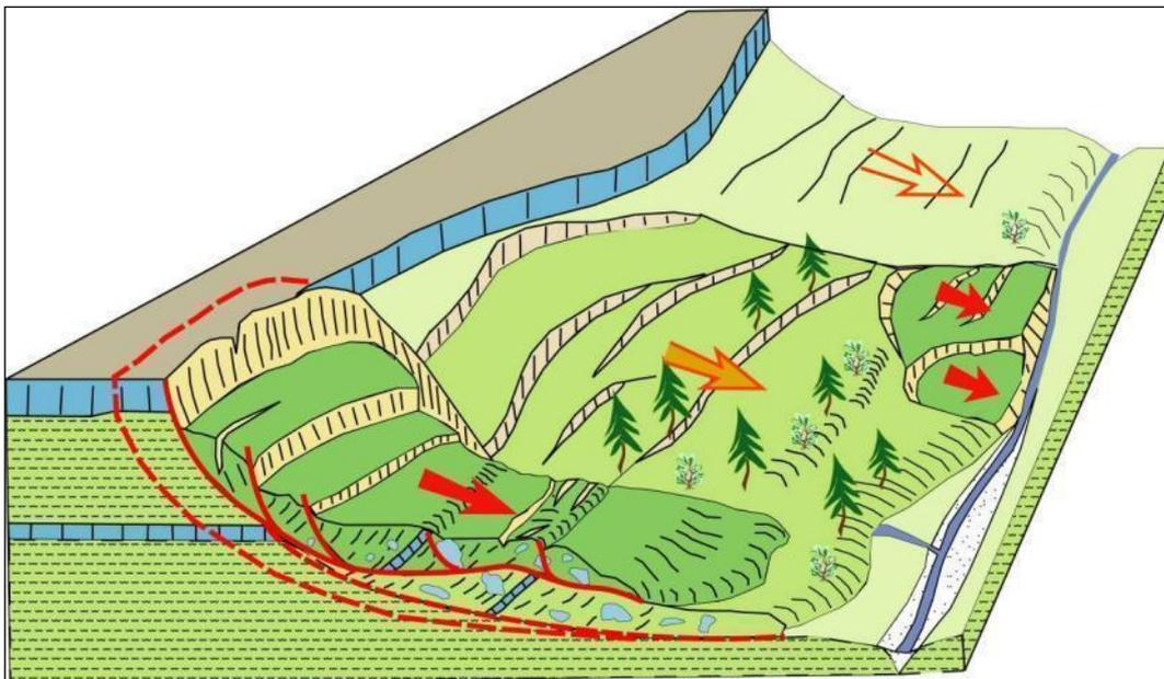
Figure 13 : Schéma conceptuel du phénomène glissement de terrain [Source : IMS<sub>RN</sub>]
