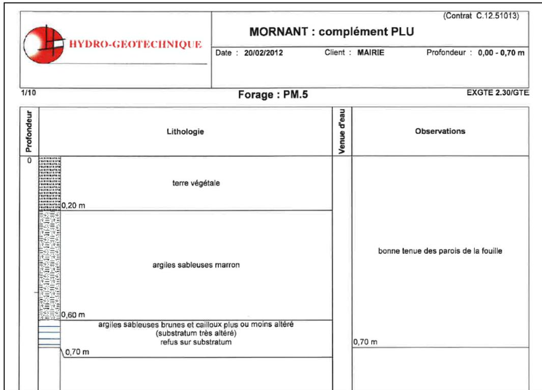
**Figure 15** : Fouille à la pelle mécanique PM5, dans le secteur de Berne, extrait de l'étude géotechnique G11 de 2012 [Source : HYDROGÉOTECHNIQUE]
