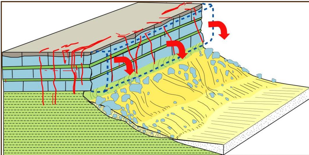
Figure 11 : Schéma conceptuel du phénomène éboulement / chutes de blocs [Source : IMS<sub>RN</sub>]
