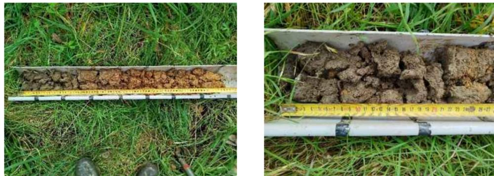
Figure 17 : Sondage n°15, non caractéristique de zones humides (traces oxydation entre 25 et 50 cm)
