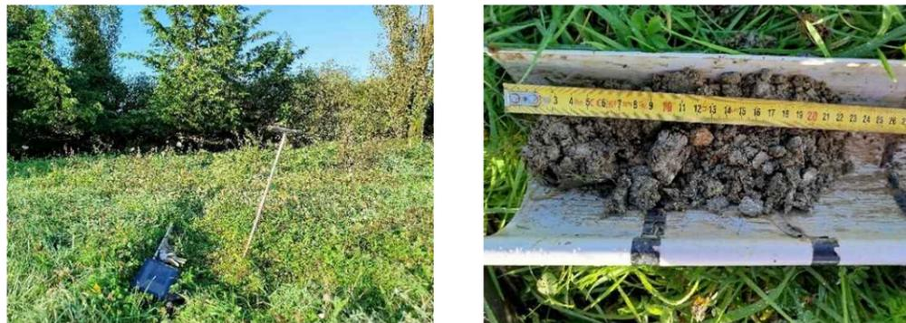
Figure 16 : Sondage n°11, caractéristique de zones humides (traces d'oxydation avant 25 cm)
