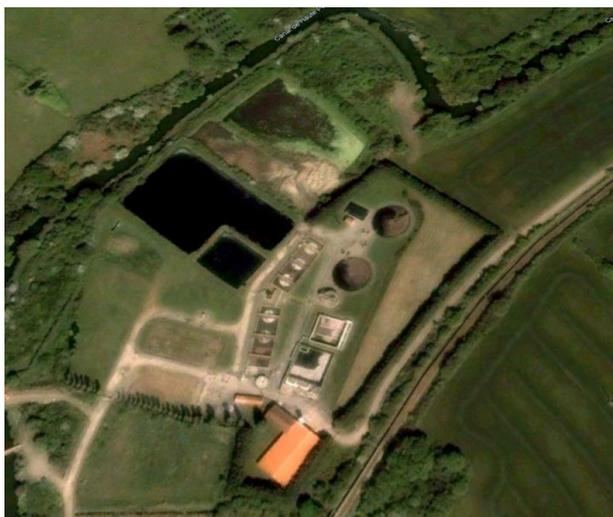
La vue aérienne de 2007 met en évidence la présence d'un nouveau bassin tampon contrairement à celle de 2004. Celui-ci a donc été construit dans les années 2005. En 2010, la station a fait l'objet d'une refonte intégrale avec la mise en place d'une filière membranaire. En 2020, une filière temps de pluie a été installée et mise en service.
