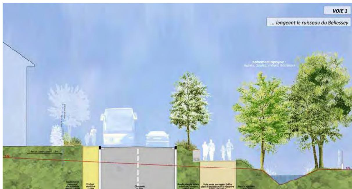
Figure 21 : Voie 1 longeant le ruisseau de Bellossey – profil en travers
