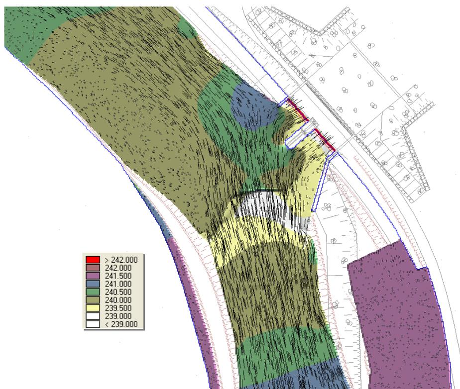
Figure 6.8 : Détail de la zone de l'ouvrage de prise avec l'altitude du plan d'eau et les vecteurs vitesse pour le débit centennal.
