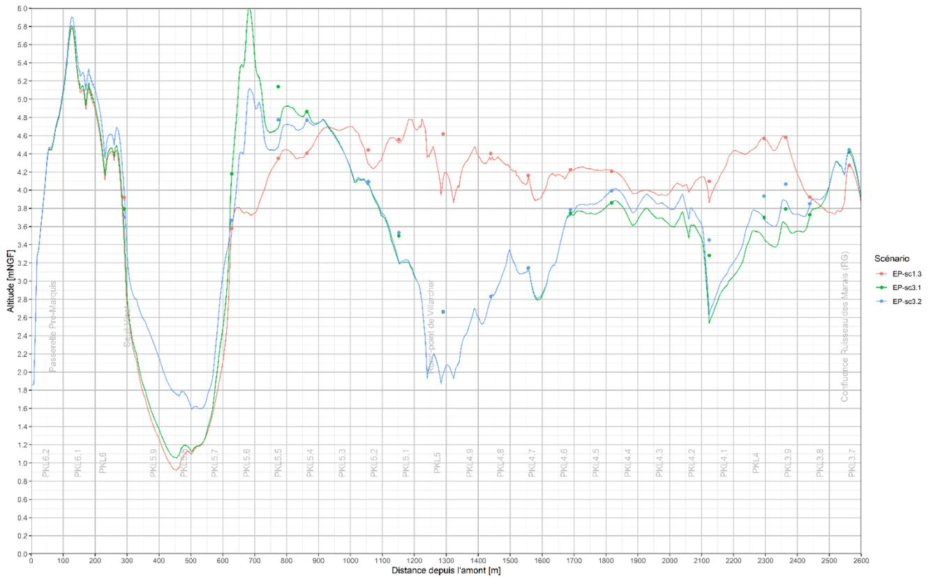
Figure 24 : Profil en long des vitesses pour la crue Q100 sur sc1., sc3.1 et sc3.2
