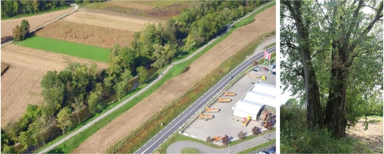
A gauche : Vue aérienne permettant de distinguer, sur la digue rive droite au premier plan, le talus aval sans végétation arborée du talus amont. A droite : peuplier noir sur le talus amont à l'amont du pont du Tremblay.
