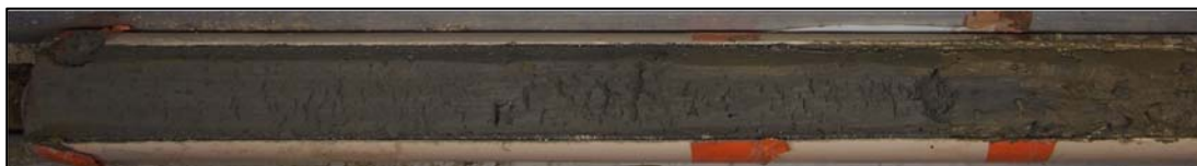
Echantillon SC3 entre 2.5 et 3.5m
