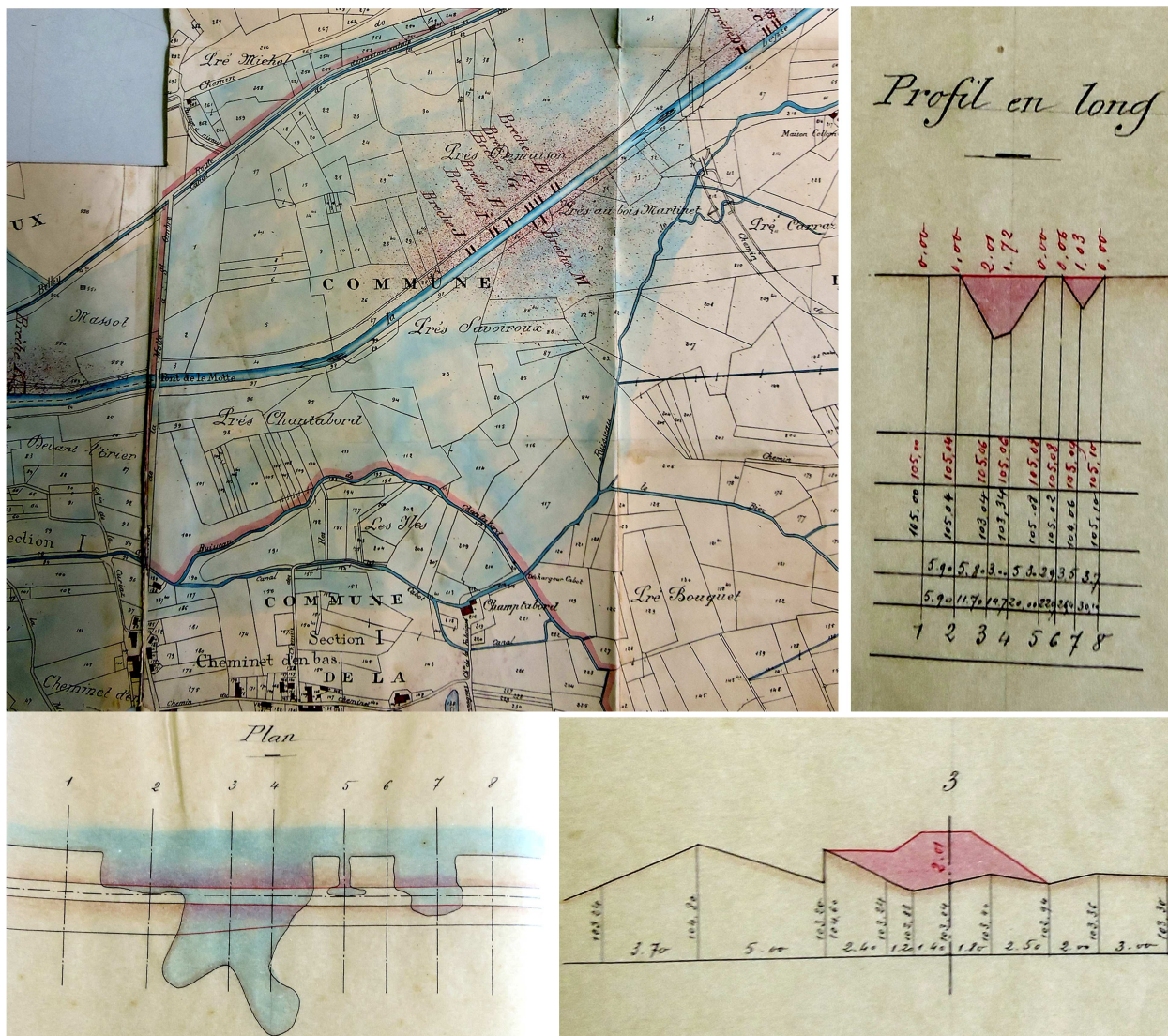
Figures 5a, 5b, 5c, 5d – Digue 4.3 - Inondation du 26/09/1896 – Plan général et profils de la brèche M (AD 73 – 40SPC 28)
