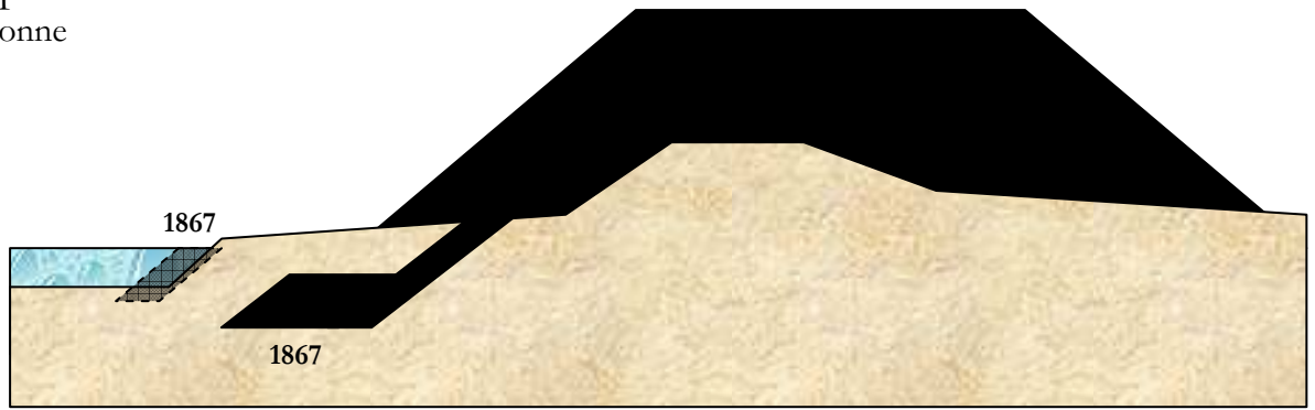
Figure 44 – Profil type 2.2.A. Représentation schématique de la dernière digue connue
