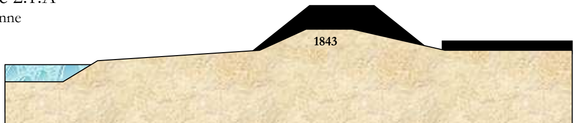
Figure 26 – Profil type 2.1.A. Représentation schématique de la dernière digue connue
