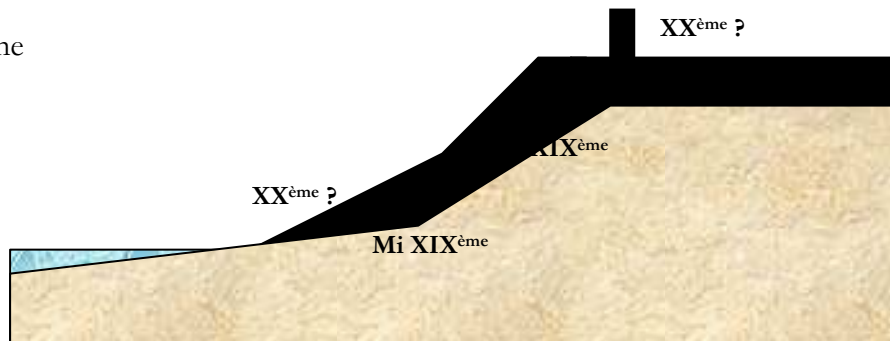
Figure 33 – Digue 3.2.B - Représentation schématique de la dernière digue connue
