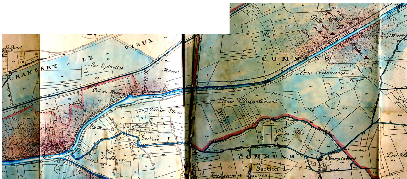
Figure 8 – Crue de 1896 - Brèches et périmètre inondé - Digue 2.2 : brèches J, K, L, 1897 (AD 73 – 40SPC 28)
