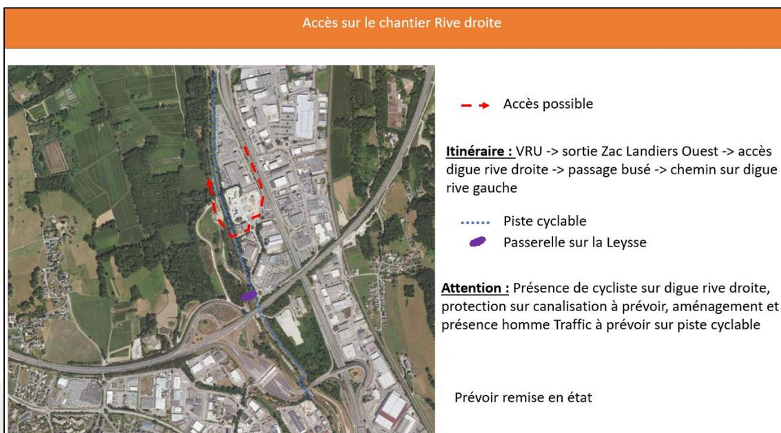
Figure 7 - Analyse de l'accès rive droite
