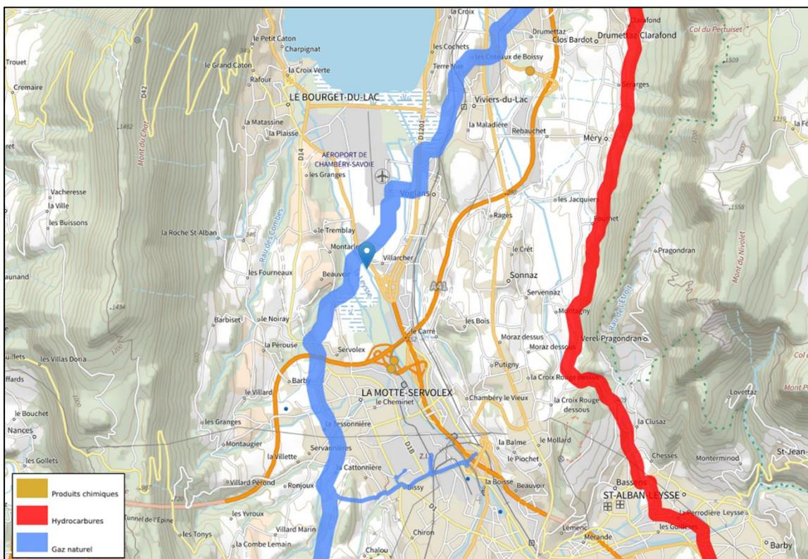
Figure 94: Canalisations de transport de matières dangereuses identifiées au droit de la zone d'étude (Source : Géorisques)
