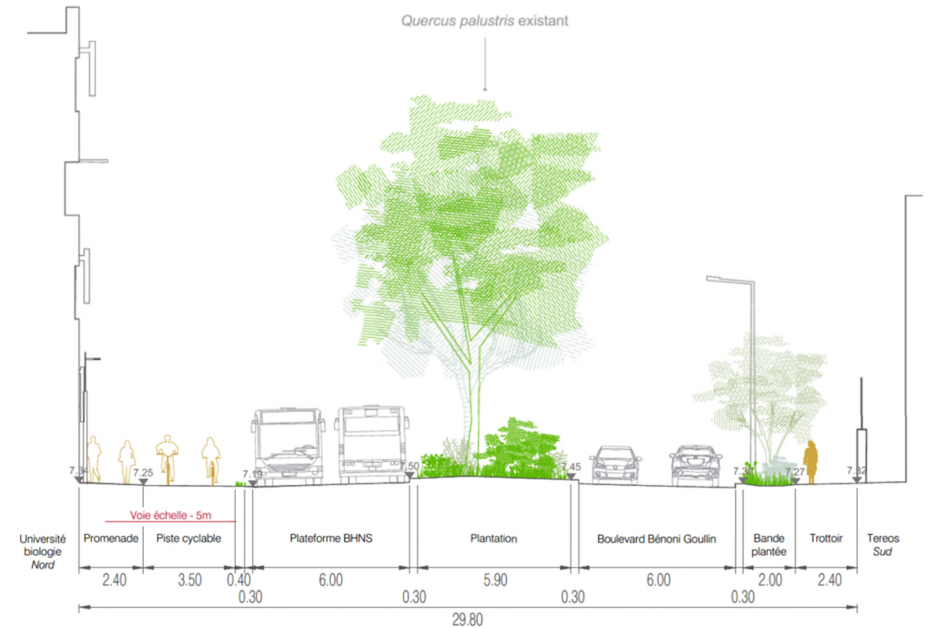
Figure 12 - Coupe type de l'aménagement boulevard B Goullin
