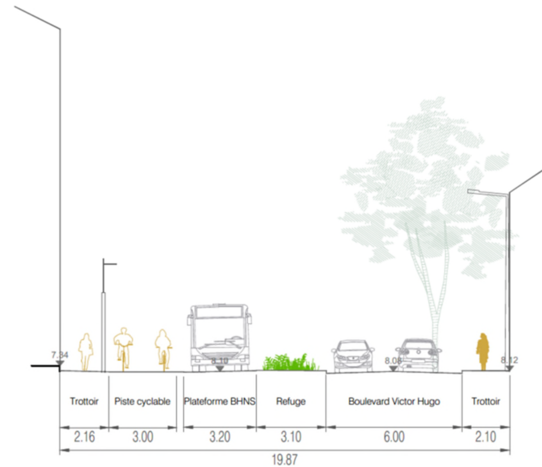
Figure 14 - Coupe type de l'aménagement boulevard V. Hugo
