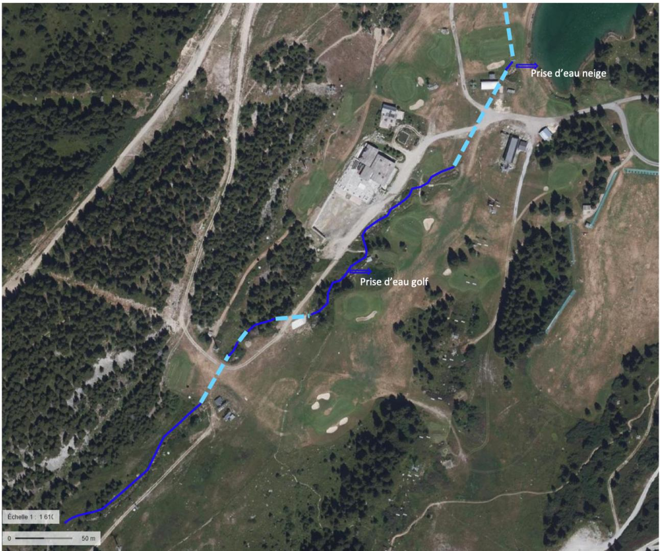
En aval de la prise d'eau du golf, le ruisseau des verdons est à nouveau busé. Une première canalisation prend naissance à la cote de 1862 mNGF, au niveau du golf, et passe entre les gares de départ des TSD des Coqs et du Biolley. Cette canalisation a une longueur de 95 mètres et est pentée à 5,1 %. Elle est dotée d'un dégrilleur.
