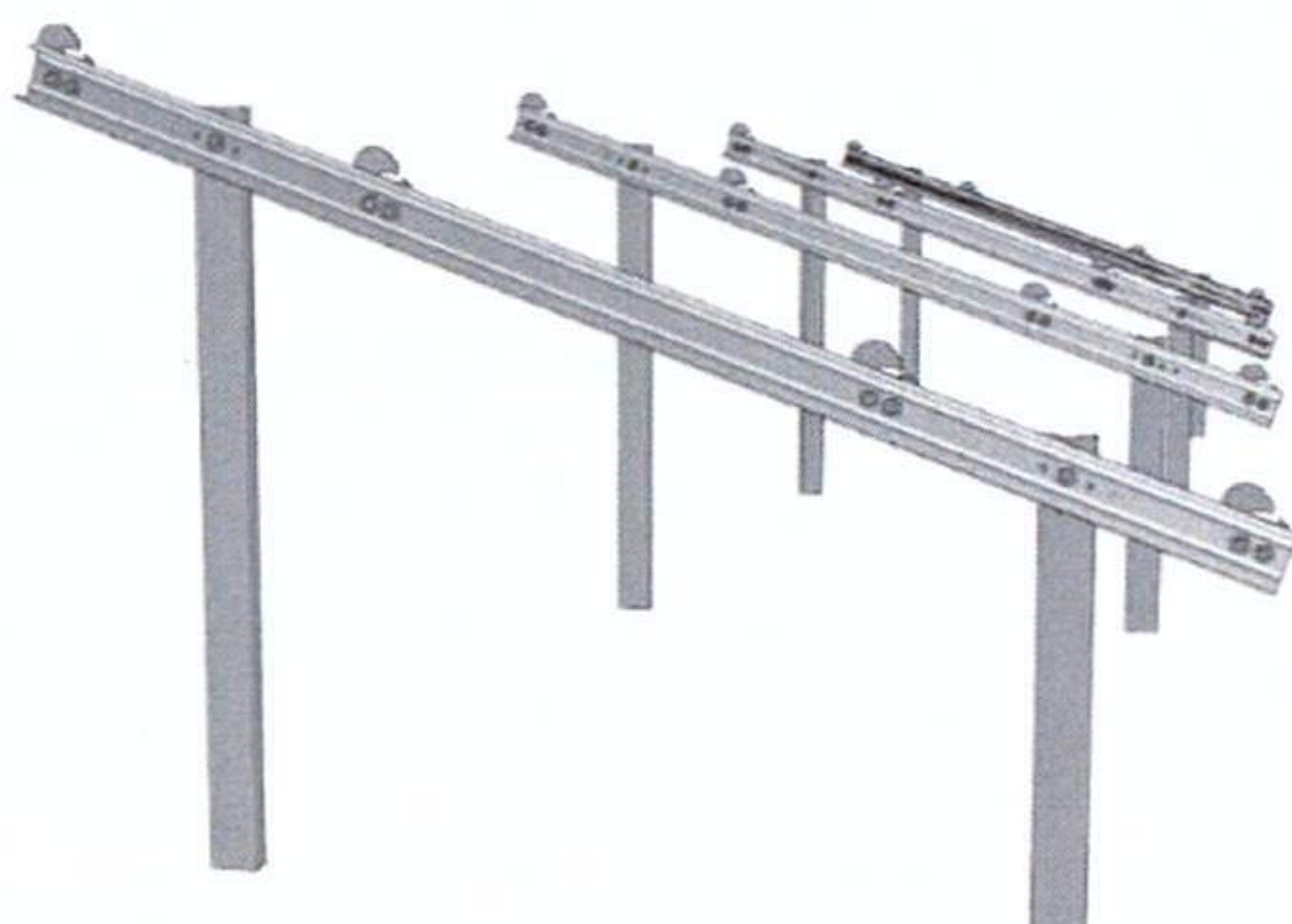
Modèle de structure sans les modules
