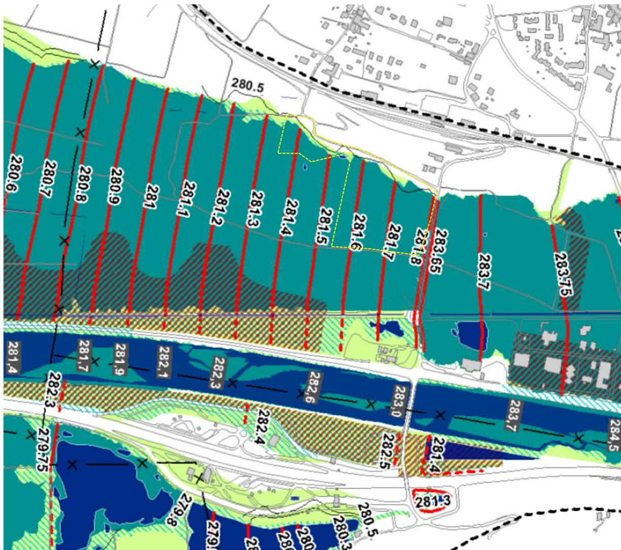
Figure 9 : Carte des côtes d'inondation pour la crue de référence et le risque de rupture de digue issue du PPRI Combe de Savoie
