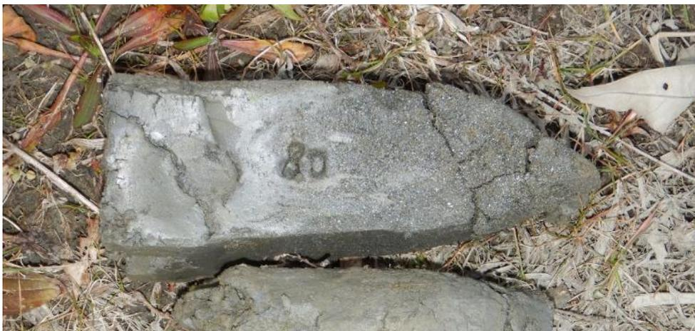
*Photo 27 : apparition d'une texture plus sableuse à 80 cm de profondeur, dans l'horizon réductique du sondage n°6.*
