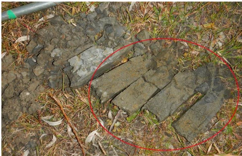
*Photo 28 : présence d'un important horizon sableux réductique (entouré en rouge) sous un gley plus argileux (sondage n°7). On notera la présence également de traces rouilles dans ces horizons.*
