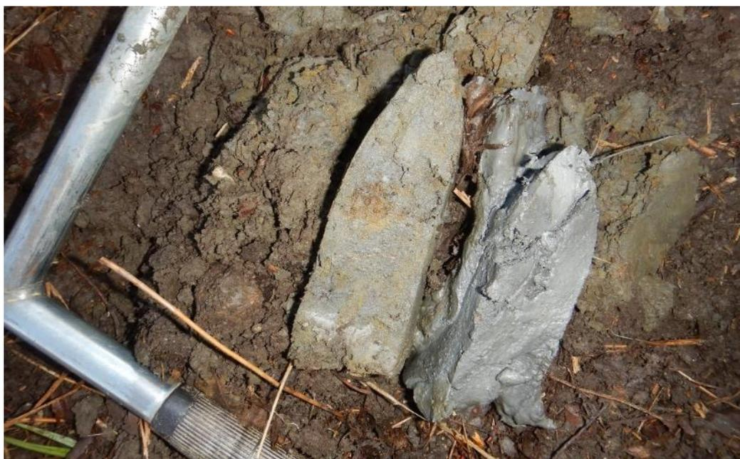
*Photo 25 : photographie issue du sondage n°8 (zone restreinte), montrant à droite un horizon réductique (gley) typique d'un réductisol*
