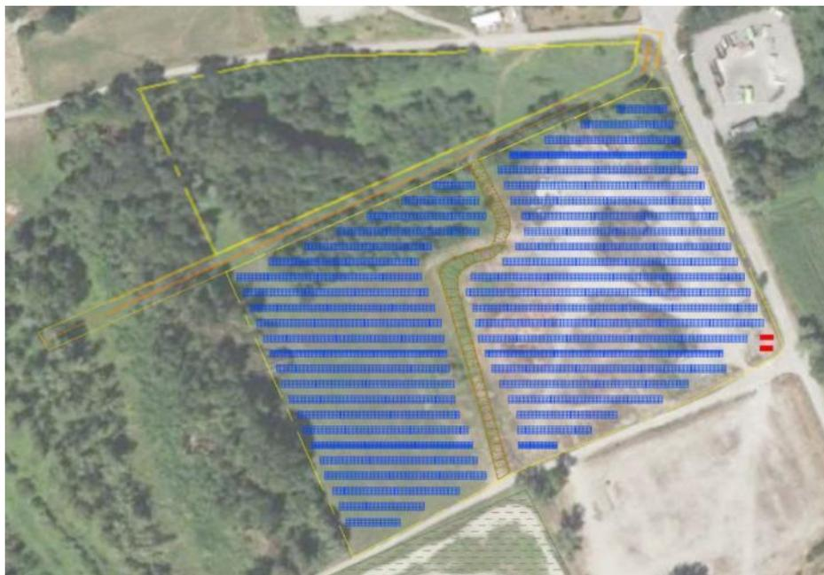
*Figure 26: Variante 1.2 – Utilisation de toute la surface au sud de la tranchée gaz*
