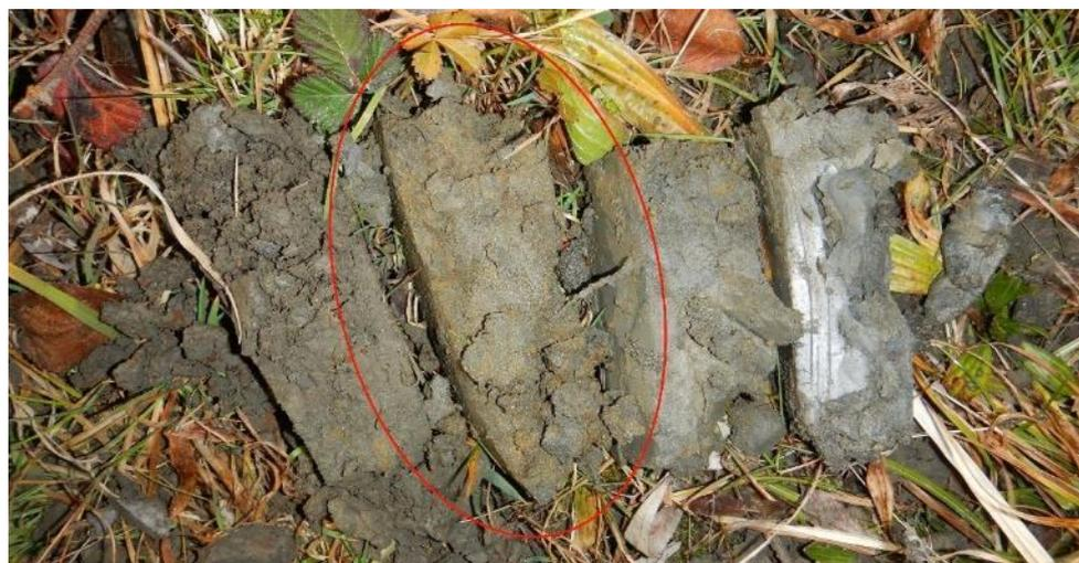
*Photo 29 : horizon sableux présentant de nombreuses traces rouilles, observé au-dessus des horizons de gley et interprété comme étant un rédoxisol (sondage n°2)*
